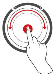
Namiesto gest môžete nastavenia zmeniť točením hlavného nastavovacieho kolieska. Hlavným nastavovacím kolieskom môžete napr. prerušiť činnosti, ako automatické otvorenie veka varnej nádoby, automatické spustenie varnej nádoby alebo integrované plnenie vodou. Okrem toho môžete hlavným nastavovacím kolieskom vypnúť výstražný tón, ktorý sa rozoznie pri výzve na akciu.
