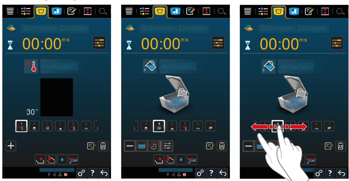
Ak ste spustili inteligentný varný proces, prepne sa displej zakrátka na kokpit. Tu sa zobrazia všetky varné kroky, ktoré postupne vykonáva inteligentný varný proces. Aktívny varný krok je označený. Varné kroky, ktoré sa vykonajú v budúcnosti, sú šedé. Keď sa varný krok ukončí, zobrazí sa automaticky nasledovný varný krok.
