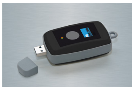
Alternativně k aplikaci MEIKO Connect CC-datový modul pro pohodlný přenos provozních dat přes Bluetooth
