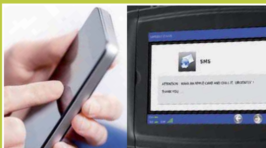
Súprava GSM na posielanie upozornení o stave stroja na mobilný telefón používateľa a na prijímanie správ z mobilného telefónu používateľa
