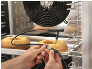
Vícebodová sonda jádra (standardní) a vyhřívaná sonda jádra (volitelná)
