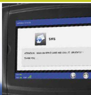
Súprava GSM na posielanie upozornení o stave stroja na mobilný telefón používateľa a na prijímanie správ z mobilného telefónu používateľa
